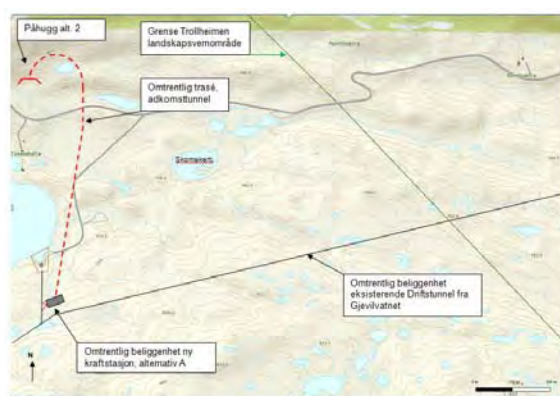
Figur 2 Oversikt alternativ A2 – ny kraftstasjon og atkomsttunnel og bruk av eksisterende inntak ved Tovatna. Tunnelpåhugg nord for Tovasshytta.
